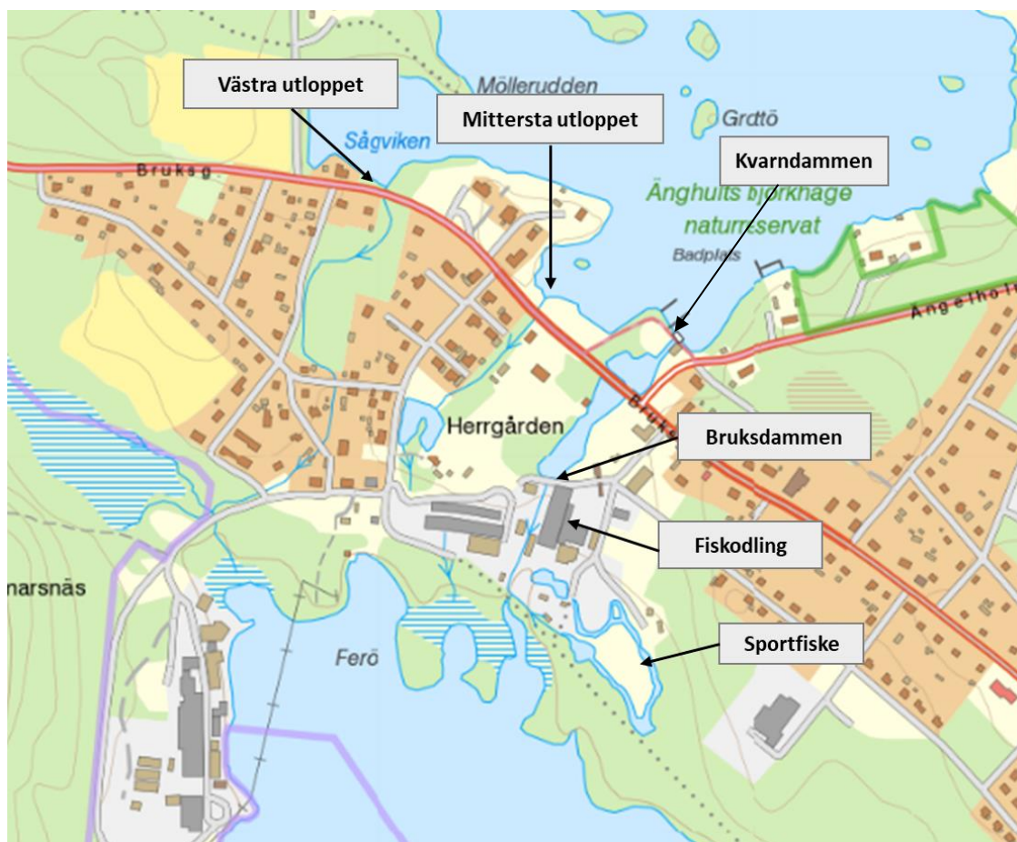
Figur 3. Avrinningen från Ånghultasjön sker via tre fårar. Huvuddelen av vattnet går via "Utloppet Ånghultasjön". Fiskodlingen ligger i anslutning till "Bruksdammen" och utloppsvattnet från fiskodlingen går till en anlagd sportfiskesträcka innan vattnet återförs till Mörrumsån.
